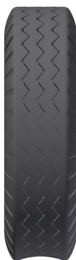
Falta de pressão
